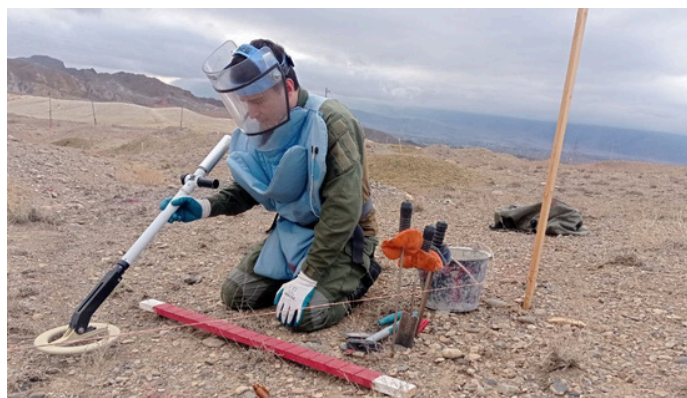
Un démineur de la FSD travaillant avec précision à l'aide de son détecteur, à la recherche d'un signal indiquant la présence de métal. (Tadjikistan, octobre 2024)
